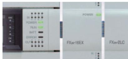
An die FX3U können sowohl FX3U-Erweiterungen als auch Erweiterungsgräte der FX0N- und FX2N-Serie angeschlossen werden.
